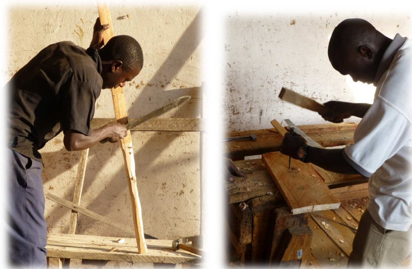
Abbildung 2: Mit viel handwerklichem Geschick wird in der Tischlerei Holz bearbeitet. Links: Herstellung einer Holzpassung. Rechts: Loch ausstemmen. Elektrische Geräte würden die Arbeit beschleunigen und erleichtern.
